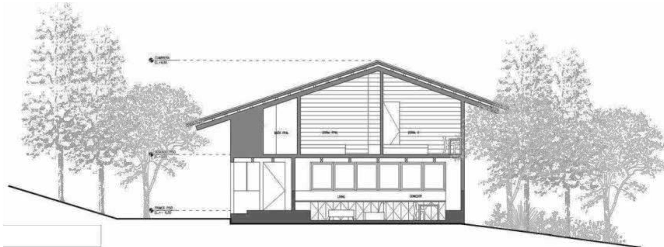
Corte Longitudinal Casa 02 escala 1:100
